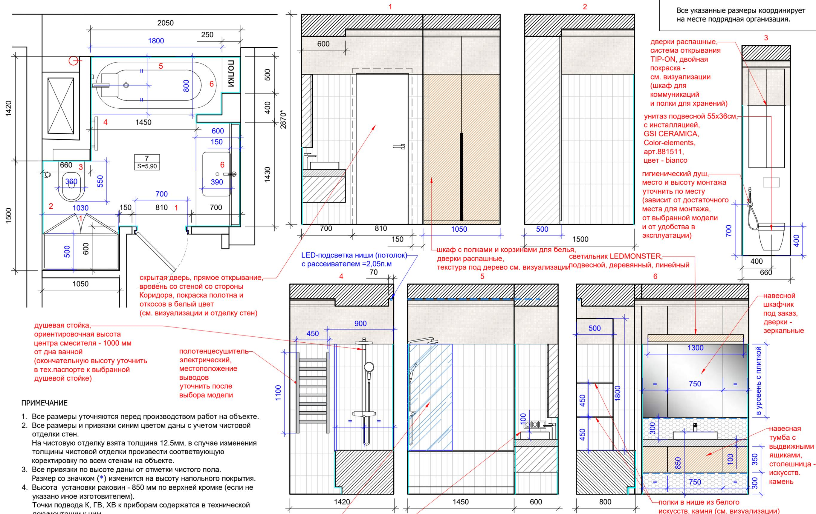
дверки распашные, система открывания TIP-ON, двойная покраска - см. визуализации (шкаф для коммуникаций и полки для хранения)
