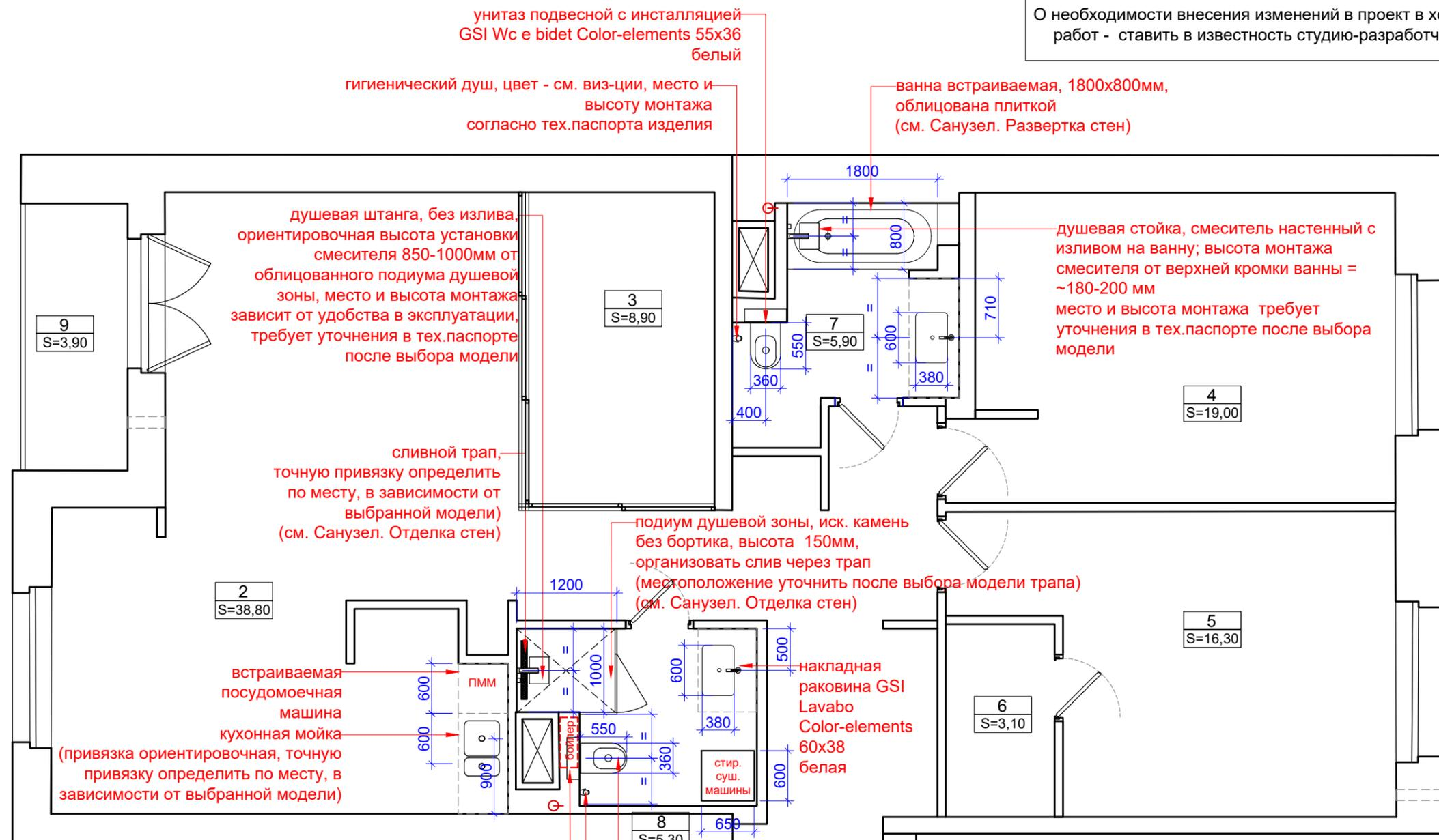
душевая штанга, без излива, ориентировочная высота установки смесителя 850-1000мм от облицованного подиума душевой зоны, место и высота монтажа зависит от удобства в эксплуатации, требует уточнения в тех.паспорте после выбора модели
