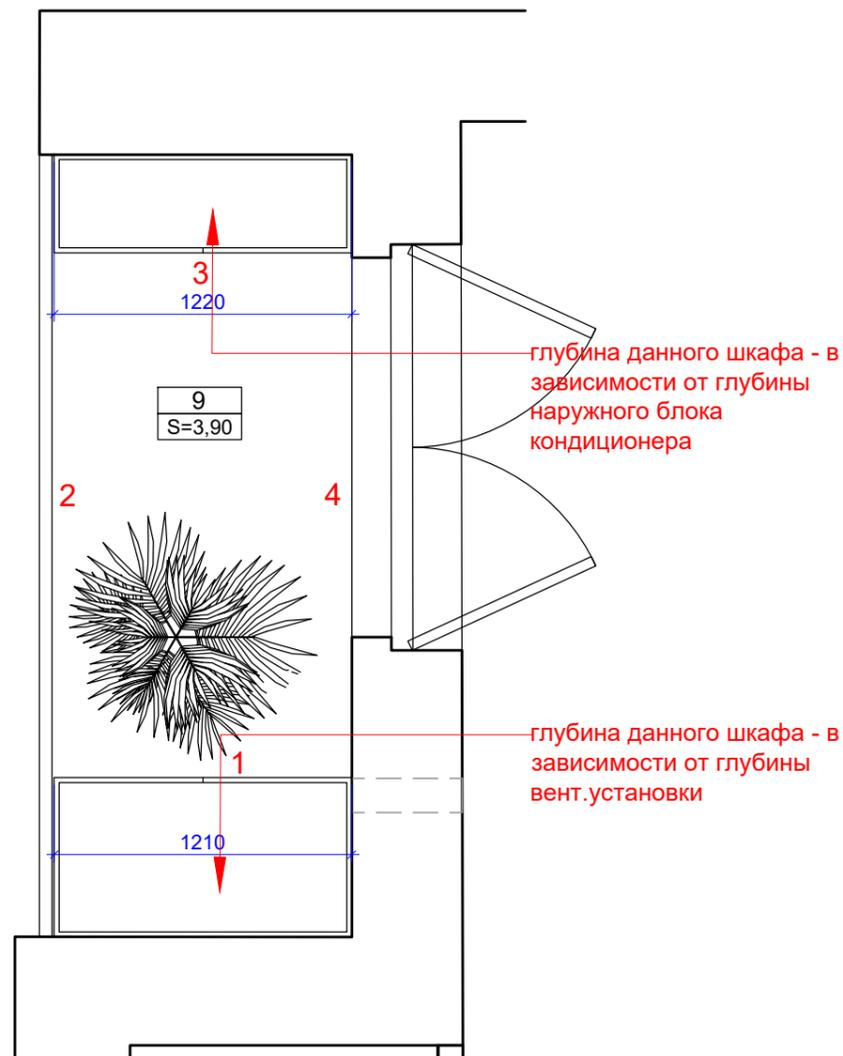
глубина данного шкафа - в зависимости от глубины наружного блока кондиционера
